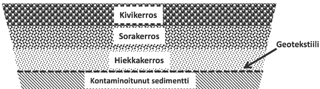
Kuva 2. Esimerkki sedimenttien eristävässä päällystyksessä käytettävästä rakenteesta (Mohan et al. 2000).
